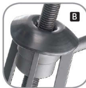
B La tapa de caucho permite colocar las garras en el husillo de forma fácil y rápida. También evita que las garras se separen del husillo durante la operación
