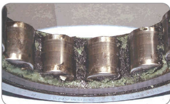
Degradación del lubricante causada por corrientes eléctricas
